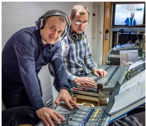
Mit ~30 Headsets und ~40 Mikros für das Orchester werden 76 Tonkanäle live gemischt. Für die Übertragung des Bildes an sämtliche Stellen über, unter, hinter und neben der Bühne werden 2 Kameras und 9 TV Bildschirme verwendet. Insgesamt wurden für sämtliche Licht-, Ton- und Videoübertragungen rund 500 Meter Kabel verlegt.
